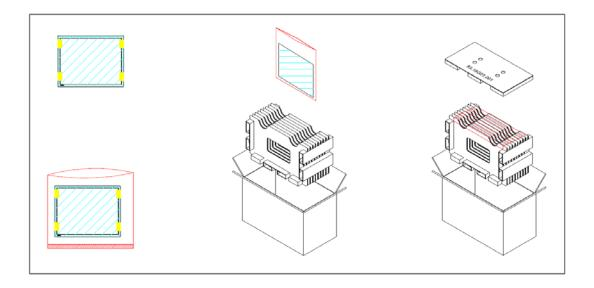
Max capacity: 8 TFT-LCD module per carton
